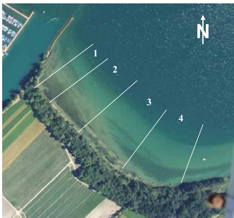
Abb. 1: Projektgebiet Naturschutzgebiet Gals, südöstlich der Zihlmündung. Aufnahme von 2005. Ausgeführte Massnahmen: Abschnitt 1: unbefestigtes Ufer, Abschnitt 2: Kiesschüttung, Abschnitt 3 : Wellenbrecher, Abschnitt 4: Buhnen
